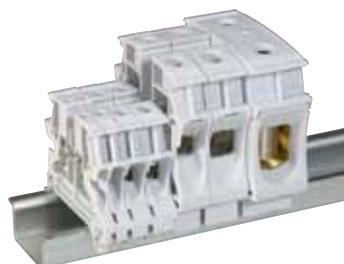
Permite la unión eléctrica y mecánica entre dos conductores eléctricos. Dos puntos para la unión equipotencial por peines o barras entre varias clemas. Para montaje en riel DIN tipo  $\perp$  7,5 mm y  $\perp$  15 mm EN 60715. Material aislante poliamida V2 conforme UL94. Autoextinguible a 960°C según la norma IEC 60695-2-11.
